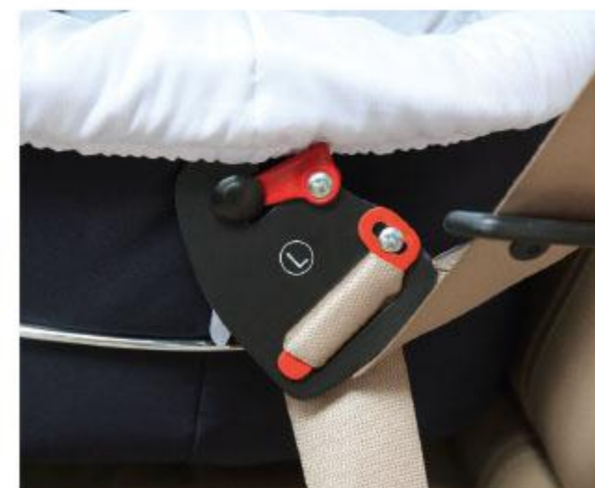
Pormenor do sistema de fixação dos cintos do automóvel
